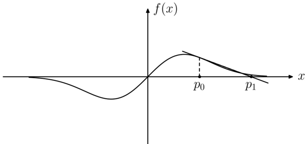
Seja  $f \in \mathcal{C}^2[a, b]$ . Se  $p \in [a, b]$  é tal que  $f(p) = 0$  e  $f'(p) \neq 0$ , então existe um  $\delta > 0$  tal que o Método de Newton gera uma sequência  $\{p_k\}_{k=0}^{\infty}$  convergente para  $p$  para qualquer aproximação inicial  $p_0 \in [p - \delta, p + \delta]$ .
