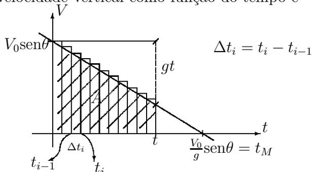
Se  $t > 0$  e  $0 = t_0 < t_1 < \dots < t_n = t$  é uma subdivisão do intervalo  $[0, t]$  e  $\Delta t_i = t_i - t_{i-1}$ . Como em cada intervalo  $[t_{i-1}, t_i]$  a velocidade é aproximadamente igual a  $V_v(t_{i-1})$  temos que neste intervalo o deslocamento vertical é aproximadamente igual a
